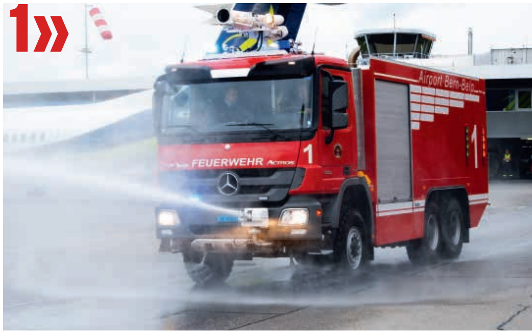
Florian 1 mit eingeschaltetem Frontwerfer und Selbstschutz.
